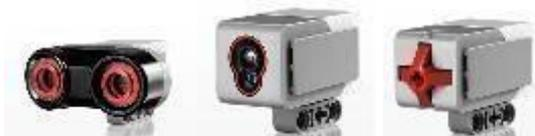
Датчик касания    Ультразвуковой датчик    Датчик цвета
